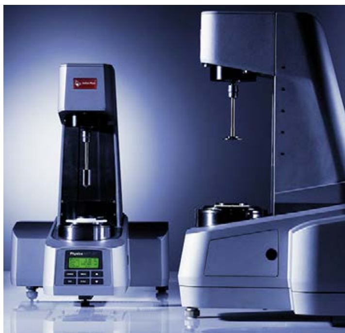
Reometr elektroniczny MCR 301 z możliwością badań w obszarze działania pola magnetycznego MCR 301 electronic rheometer that enables performing tests in the area of a magnetic field
