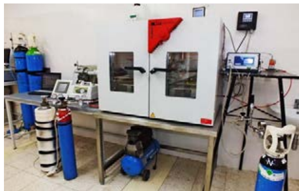
Stanowisko do badania przepływów w ośrodkach porowatych Laboratory apparatus for testing fluid flow in porous media
