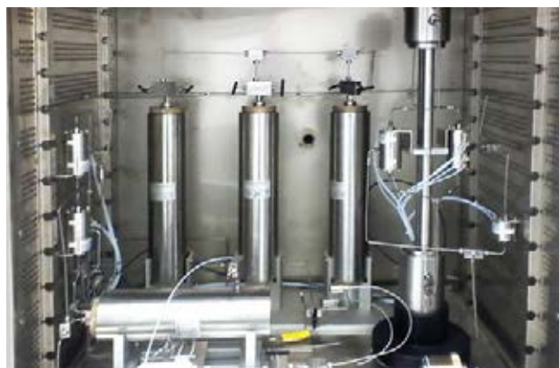
Stanowisko do badań procesów wypierania ropy naftowej Laboratory apparatus for testing oil displacement processes
