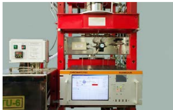
Stanowisko do hydratacji siarkowodoru Hydrogen sulfide hydration laboratory apparatus
