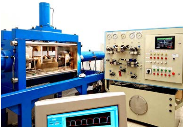
Pięciocylinndrowa prasa hydrauliczna CWS z pulpitem sterowniczym CEC hydraulic press with control panel
