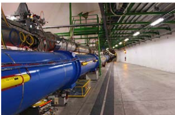
Fragment akceleratora LHC w miejscu wstrzykiwania do jego jonowodu wiązki protonów z mniejszego akceleratora SPS w punkcie nr 8. Proton injection point from SPS accelerator into LHC in access point no. 8. View of LHC tunnel
