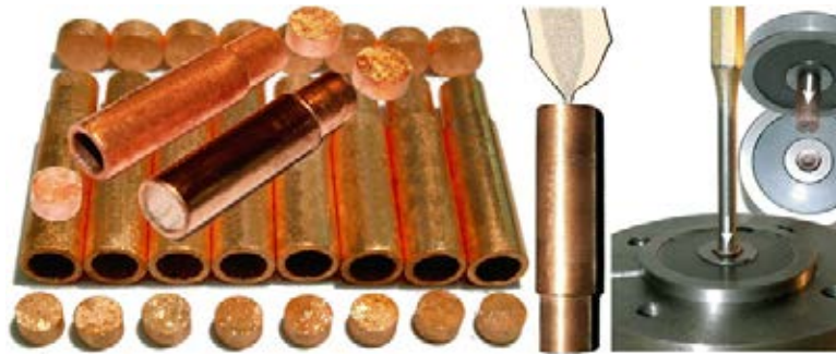
Przygotowanie materiału wsadowego do procesu CWS Preparation of powder charge for CEC processing
