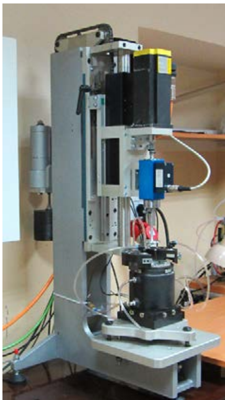
Stanowisko do badań wzdłużnych łożysk ślizgowych smarowanych cieczami magnetycznymi A station for longitudinal tests of sliding bearings lubricated with magnetic fluids
