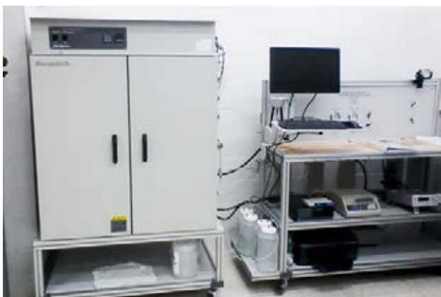
Stanowisko do badań ciśnienia kapilarnego i oporności płynów złożonych Laboratory apparatus for testing capillary pressure and reservoir fluid resistivity
