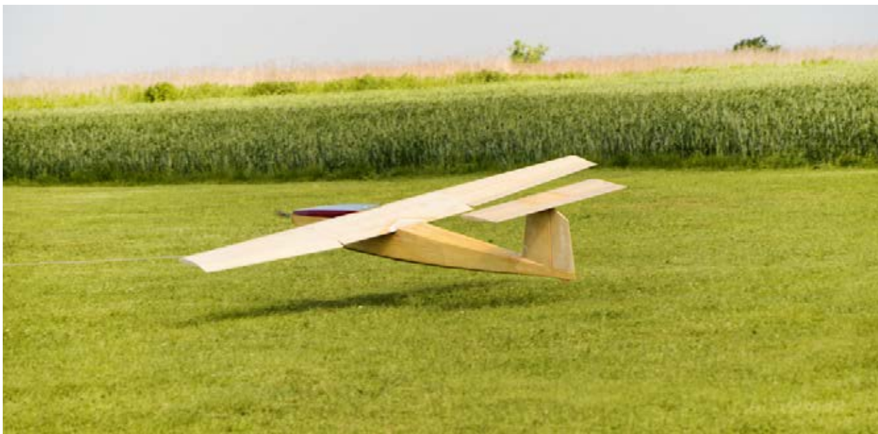
Prototyp bezpilotowego aparatu latającego zasilanego jednostką napędową zawierającą ogniwa paliwowe A prototype of an unmanned aerial vehicle powered by a unit containing fuel cells
