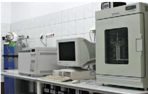
Stanowisko do badań reakcyjności skał z CO 2 CO 2 – rock reactivity apparatus
