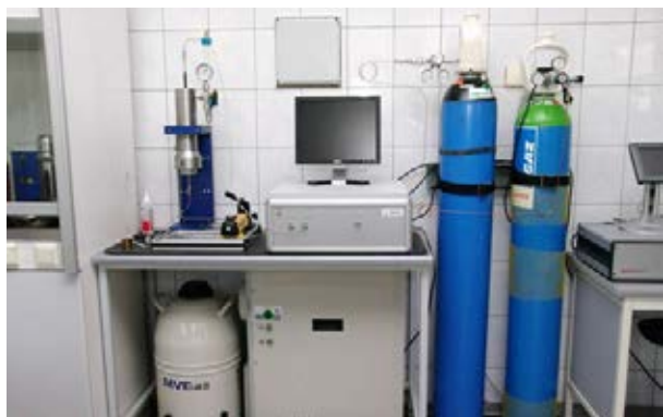
Stanowisko do pomiaru mikroprzepuszczalności Pulse-decay permeameter
