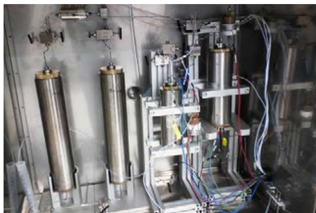
Stanowisko do badań ciśnienia kapilarnego i oporności płynów złożonych Laboratory apparatus for testing capillary pressure and reservoir fluid resistivity
