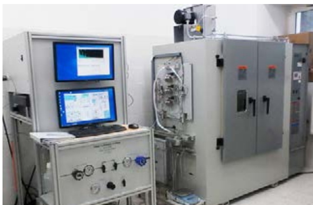
Stanowisko do badań procesów wypierania ropy naftowej Laboratory apparatus for testing oil displacement processes
