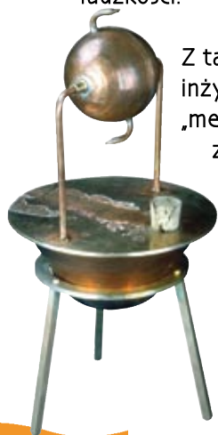
Model turbiny parowej Herona autorstwa Karen Fisher Dzięki uprzejmości Smith College, program Historii Nauki i Technologii (HSC)
